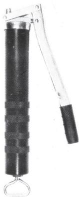
Compressore automatico con arresto asta a spostamento laterale e tacca di sicurezza. Corpo serbatoio grasso in acciaio brunito sp. 15/10. Testata in acciaio zincato con pistoncino in acc. temperato e rettificato. Stantuffo in gomma antiolio.
